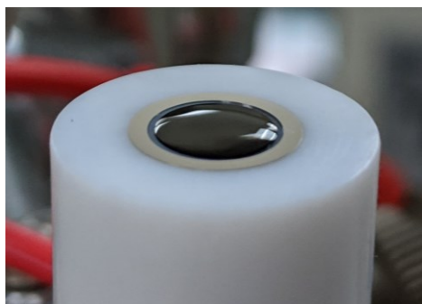
Obr. 5: Aktivní plocha rotační prstencové diskové elektrody s nanoseným roztokem platinových nanočástic před evaporací rozpouštědla.
